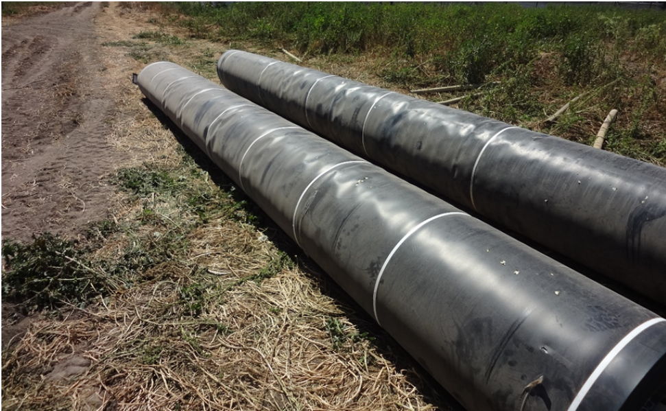
Fotografía 5. Membrana impermeable utilizada en vertederos. Iván Ramírez.
