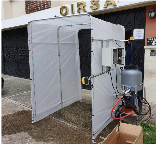
Figura 3: Túnel de desinfección peatonal
