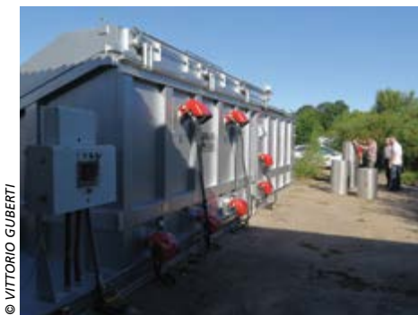
Foto 15 Colocación de un incinerador en una zona muy infectada en Letonia.
